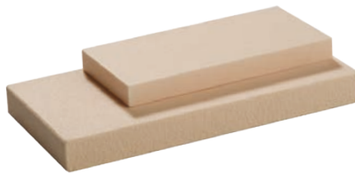
Platten aus Aluminiumoxid mit polierter Oberfläche, die als Gleitsteine in Durchschuböfen eingesetzt werden
