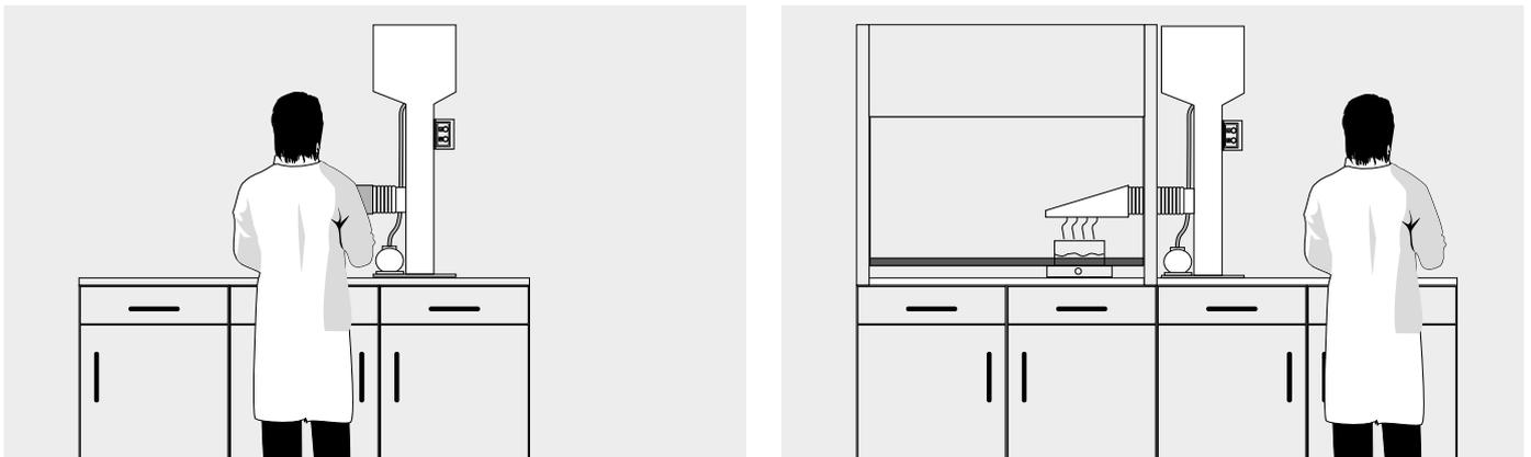
Der Abluftwäscher C20 kann flexibel positioniert werden. Mögliche Aufstellungsorte sind neben dem Labortisch und Boden auch dort gegeben, wo der Einbau eines fest installierten Abluftwäschers aufgrund von Platzmangel nicht möglich ist. Die Aufstellung im Abzugsinnenraum ist allerdings ausgeschlossen.
