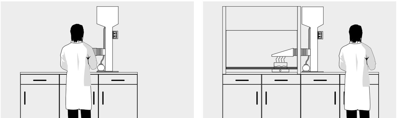
Der Abluftwäscher C20 kann flexibel im Labor positioniert werden. Mögliche Aufstellungsorte sind neben dem Labortisch und Boden auch dort gegeben, wo der Einbau eines fest installierten Abluftwäschers aufgrund von Platzmangel nicht möglich ist. Die Aufstellung im Abzugsinnenraum ist allerdings ausgeschlossen.
